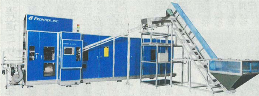
フロンティアが中国の食品市場向けに開発した10リットル入りペットボトル成形機
