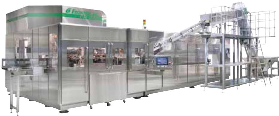
当社主力の二軸延伸ブロー成形機 (FR-24S)。プリフォームとボトルが連続駆動で搬送・移送されるロータリー式で、幅広い業種に対応可能
