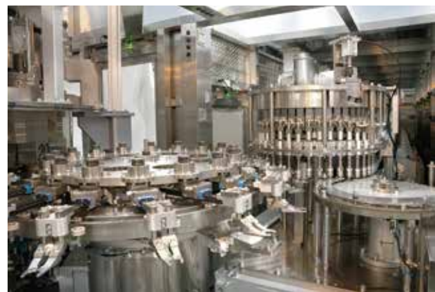
当社主力の二軸延伸ブロー成形機 (FR-24S)。プリフォームとボトルが連続駆動で搬送・移送されるロータリー式で、幅広い業種に対応可能
